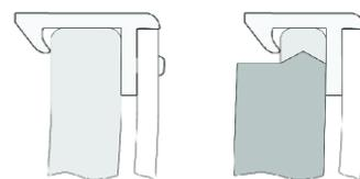
Les attaches pointues ont été réalisées spécialement pour une tenue sur le drageoir (d'où le montage doit être plus précis). Les attaches rondes reliant verre et monture tolèrent plus de marge de montage.
