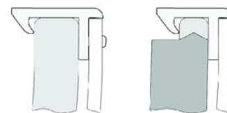
Die Klammern der gespitzten Variante sind extra fein gearbeitet, damit bei Metallbrillen allein der Halt am Metallrahmen genügt (siehe Bild). Die geschlaufte Klammern können sich nicht am Metallrahmen halten, sie müssen die ganze Glasdicke umfassen.
