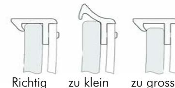
3. Halten Sie die Clipgläser vorne auf den Augending der Brillenfassung. Markieren Sie mit Filzstift die genaue Position der Klammer (um eine Drehung der Clipgläser zu verhindern: eine Klammer nahe des Nasensteigs, eine Klammer nahe des Backenteils).
