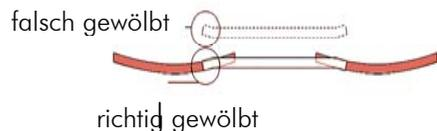
2. Setzen Sie die Brücke auf das Clipglas und bohren Sie direkt durch die Brückenlöcher das Loch für die Klammern = 1.9mm vom Rand entfernt und D 1.3mm.
